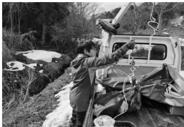
写真-3 ウインチによる積込状況
