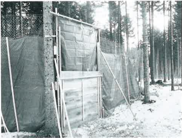
写真-2 作成した安価で軽量の入口落下扉
