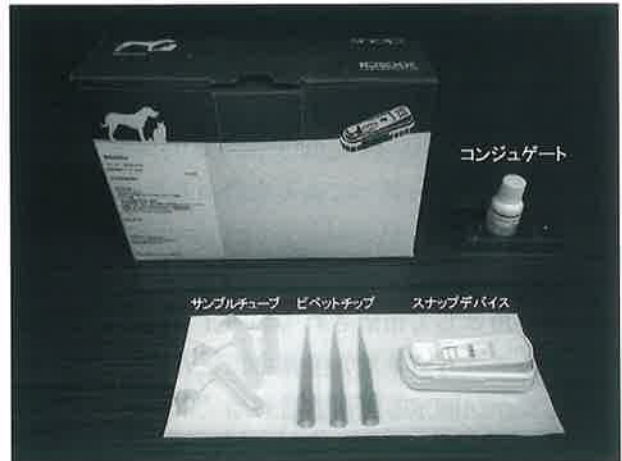
写真-2 イヌ用コルチゾルスナップに同梱されているコンジュゲート、テストチューブ、ピペットチップ、スナップデバイス
