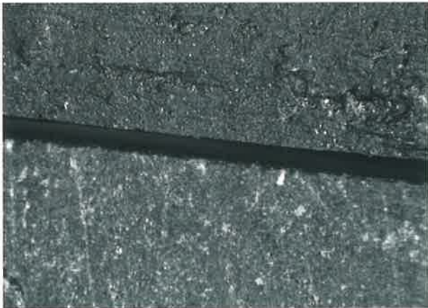
写真-8 食害操作49日経過後の過熱蒸気処理タケプラ（写真下側）と操作前（写真上側）の試験片のエッジ部分
