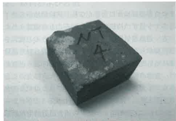
写真-13 食害操作49日経過後の無処理タケプラ試験片
