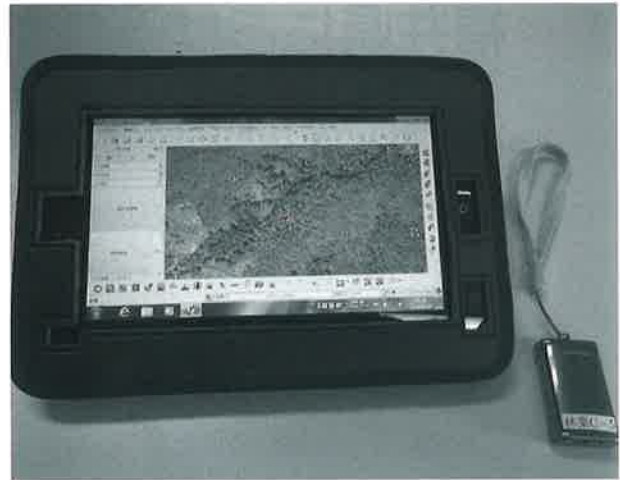
写真-3 タブレットPCとQuantumGIS, GPSロガーによる野外調査システム
