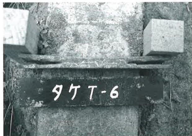
写真-3 側面に大きな食害を受けた無処理タケプラ(上)と無被害の過熱蒸気処理タケプラ(下)
