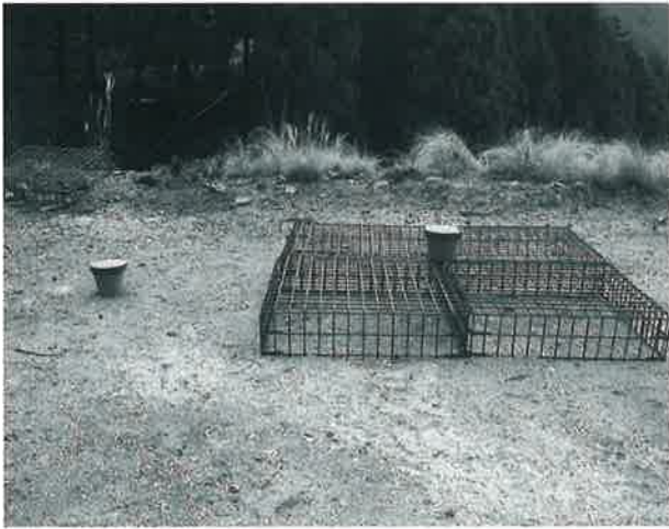
写真-4 シカ用の金網マットに対する行動観察試験区の様子
