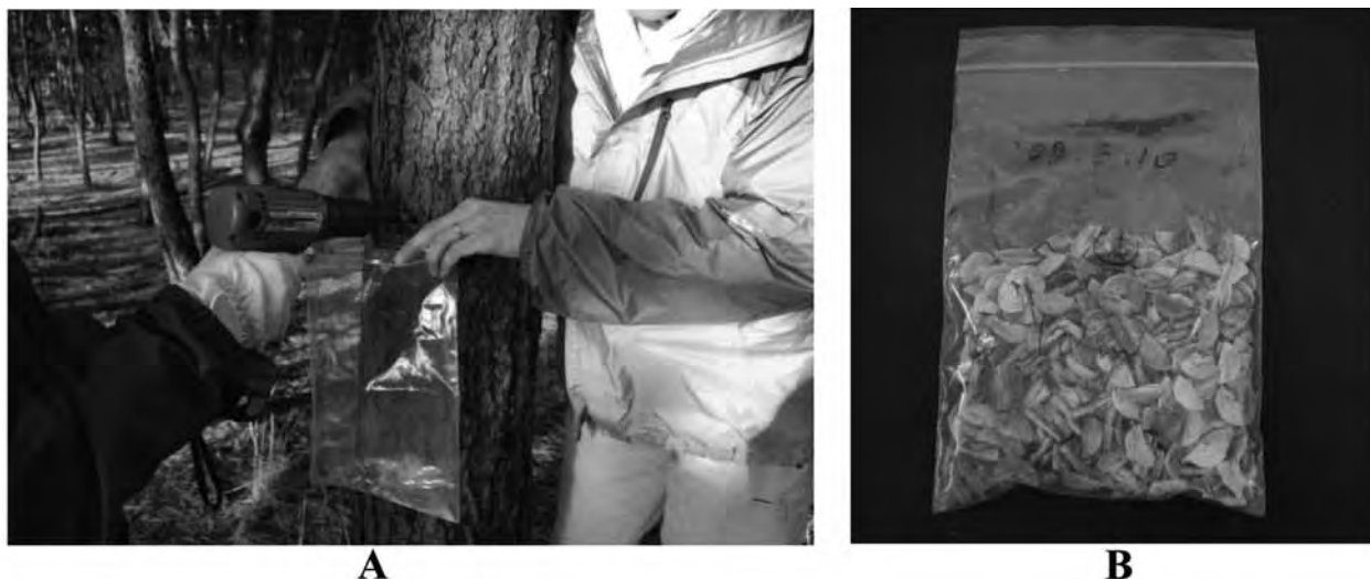
写真-2 電気ドリルを使って枯れたマツから材片を採取している様子(A)とビニール袋に入れられた材片(B)。
