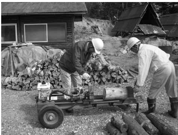
写真-1 自動薪割機の使用状況
