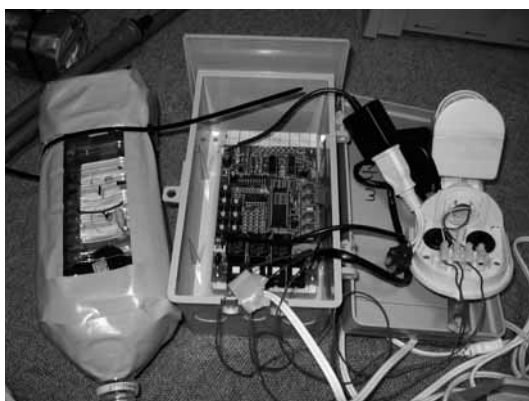
写真-2 赤外線センサー (右) と警戒音用ベル (左)
