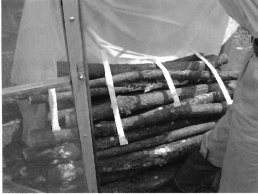
写真3 ポーベリア菌を培養した不織布の設置状況（この後シートで被覆）
