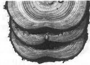
樹脂滲出中、凹みあり 枯れ枝を巻き込んだ円盤面(中央):材部中の枯れ枝の直径4.4mm, 残枝長11.2mm
