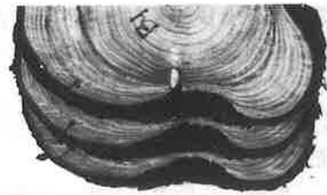
樹脂滲出中、凹みあり 枯れ枝を巻き込んだ円盤面(中央):材部中の枯れ枝の直径4.4mm, 残枝長11.2mm
