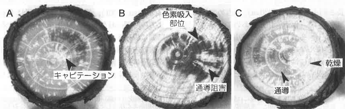
写真-2 通導阻害の進行過程(クロマツ)
