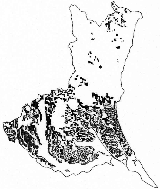
図-5 土壤が黒ボク土壤(■)および淡色黒ボク土壤(▨)のメッシュ
