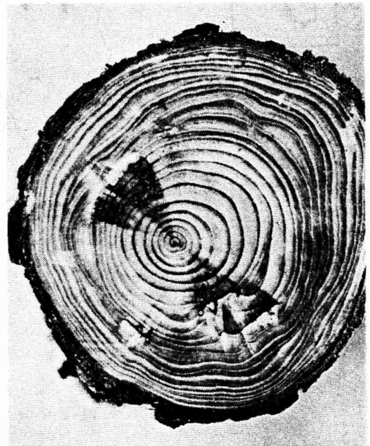
写真-3 被害材の断面(木口)にみられる食痕と黒褐色のシミ
