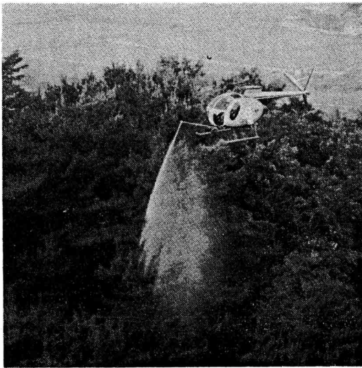
写真—2 ガン・ノズル・スプレー・システムによるマツ林に対する散布状況
