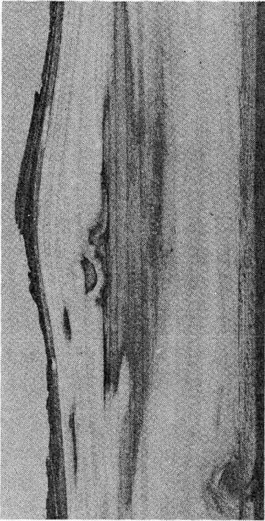
写真一4 被害材の縦断面にみられる食痕とシミ
