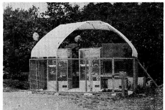
写真2 日除けしたバイオトン
