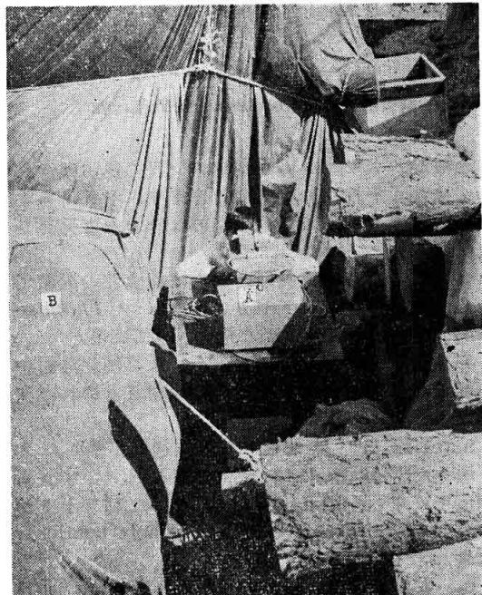
第Ⅱ図 ビニール天幕くん蒸におけるガス濃度の測定状況 (本図は第Ⅱ図Bの木材群である) A: 写真記録式干渉計型ガス分析計による測定 B: くん蒸中の天幕
